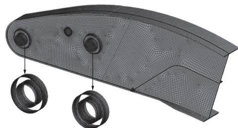
图7 面-面接触有限元模型
