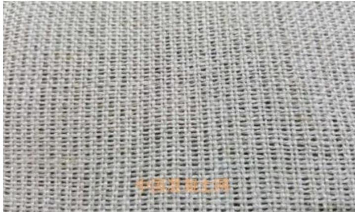
未来的建筑材料就是这种纺织混凝土。纺织钢筋混凝土（TRC）是耐用的，并且可以成形的形状多样，轻量化的结构。顾名思义，传统的 TRC 用碳或玻璃纤维作为织物而不是钢来增强。Wilhelm-Klauditz-Institut WKI 的 Fraunhofer 木材研究所的一个研究小组正在用环保的天然纤维取代这些织物。这些替代品与传统混凝土的性能相匹敌，但制造成本更低。研究人员将于 2019 年 1 月 14 日至 19 日在慕尼黑 BAU 2019 贸易博览会上展示一座天然纤维混凝土桥梁的原型。
