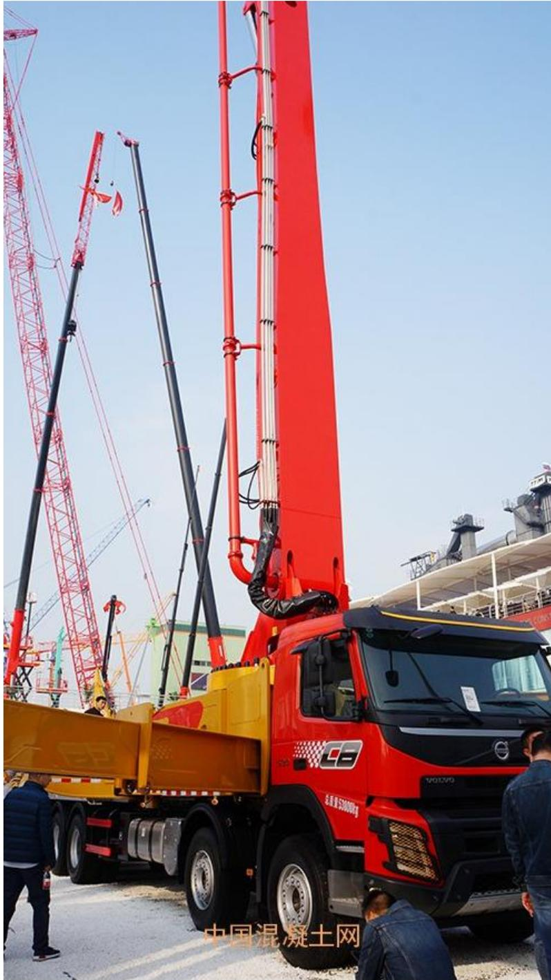
62 米混凝土输送泵车
