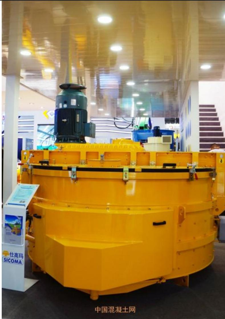
MPC1875/1250 行星式预制件混凝土搅拌机
