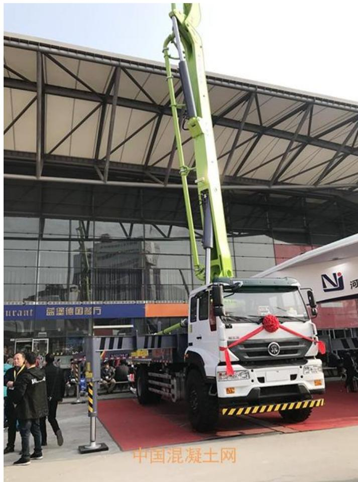
单桥 37 米混凝土泵车
