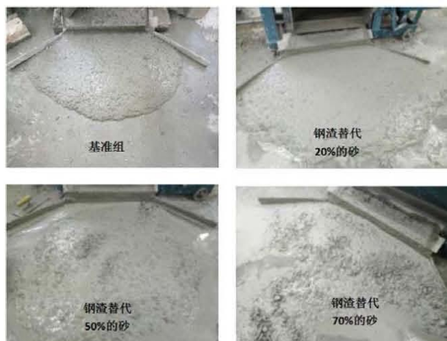
图 1 钢渣替代砂试配试验出机状态
