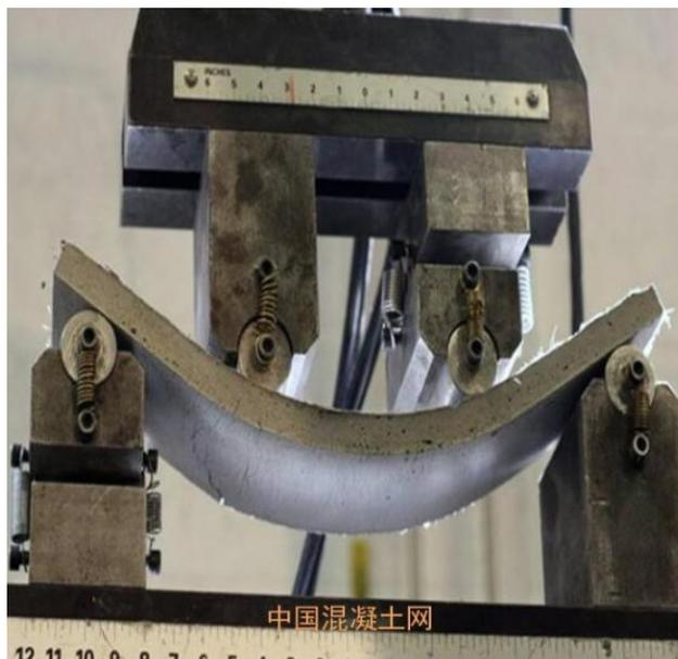
同时，混凝土内部的聚合物纤维使其承受多个“头发大小”的断裂，而不会破碎成单独的碎片。开发这种材料的研究人员表示，新的混凝土可弯曲性是普通混凝土的 400 倍，因此非常适合在地震频繁的地区使用。
