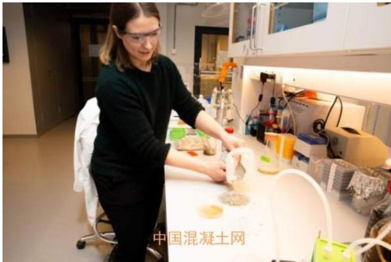
细菌混凝土包含沙子、细磨石灰石和两种特殊的细菌。使用时，需要与水、尿素和细菌需要的营养素混合。Simone Balzer Le 正在实验室中配制细菌混凝土。
