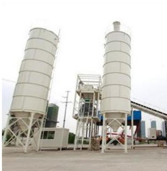
据泵送事业部搅拌设备研究院总体所所长助理张家平介绍，新型搅拌站用多个“首创”改变了传统型搅拌站的制作工艺方法，大幅降低了搅拌站的材料成本、制造成本和安装成本。整站采用全新架构模块化设计，运输方便，安装效率提升了 15%，而主体的涂装工艺经过变革后，防锈寿命达到了 20 年。除此以外，还首创了全自动骨料洗机功能。“传统搅拌站是通过型材焊接的，不适合批量生产，对生产工人的技能要求也高，而新型搅拌站大量采用折弯、冲孔、浸锌的方法，降低了生产工人的技能要求。”
