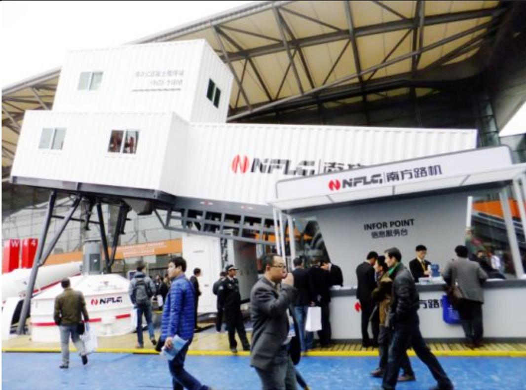
南方路机移动式混凝土搅拌站
