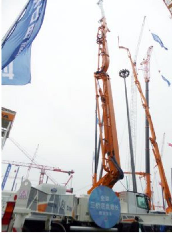
中联重科三桥 56 米碳纤维臂架泵车
