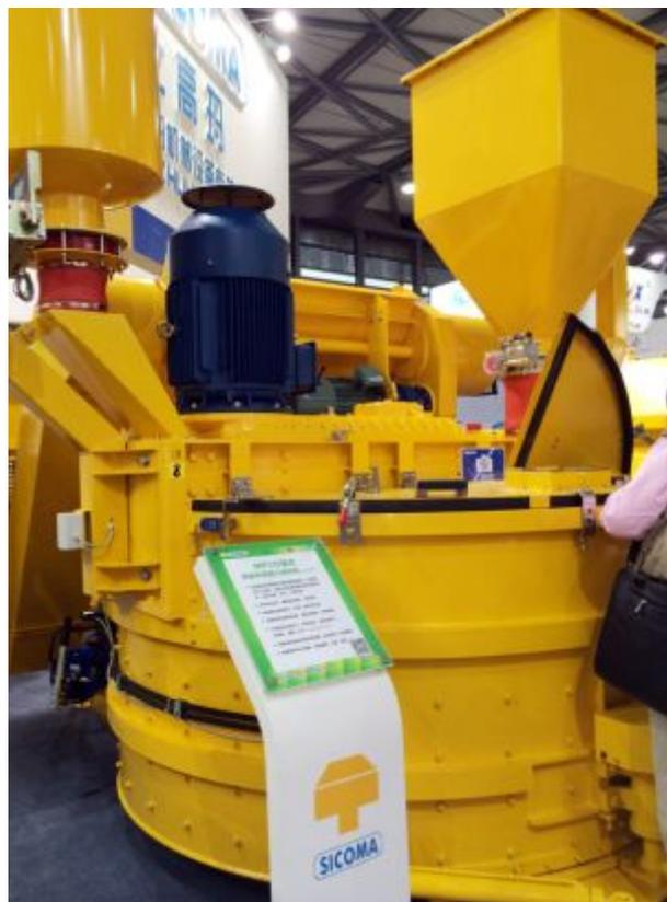
MPC 行星式预制件混凝土搅拌机
