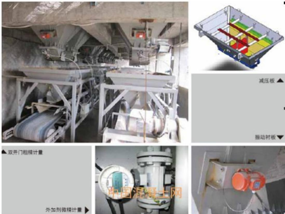
• 可选配微量外加剂计量系统，专为引气剂等微量液体外加剂设计，满足国标误差下，最小添加量可到 0.4kg/方。
