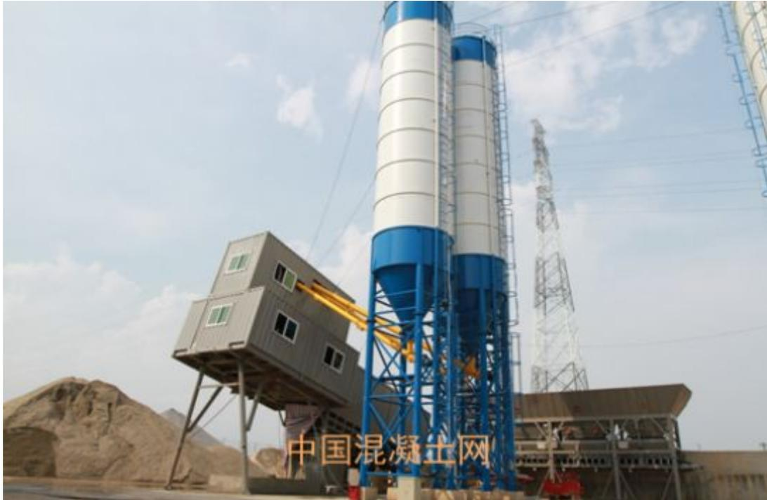
YHZS150 环保型移动式混凝土搅拌站广东长大工地
