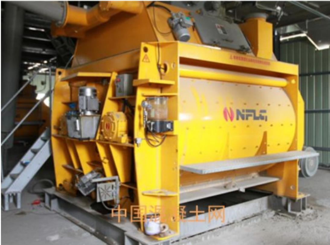
三. 骨料二次投料工艺，砂浆裹石法生产，满足高铁工艺。
