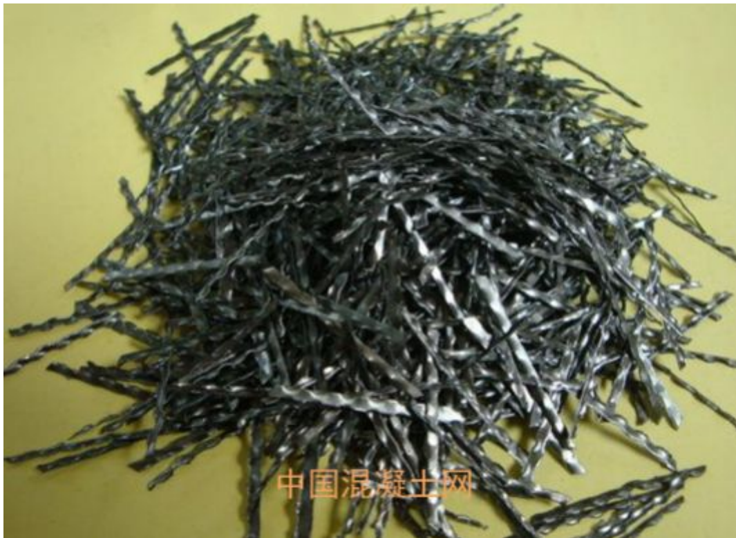
钢纤维混凝土
