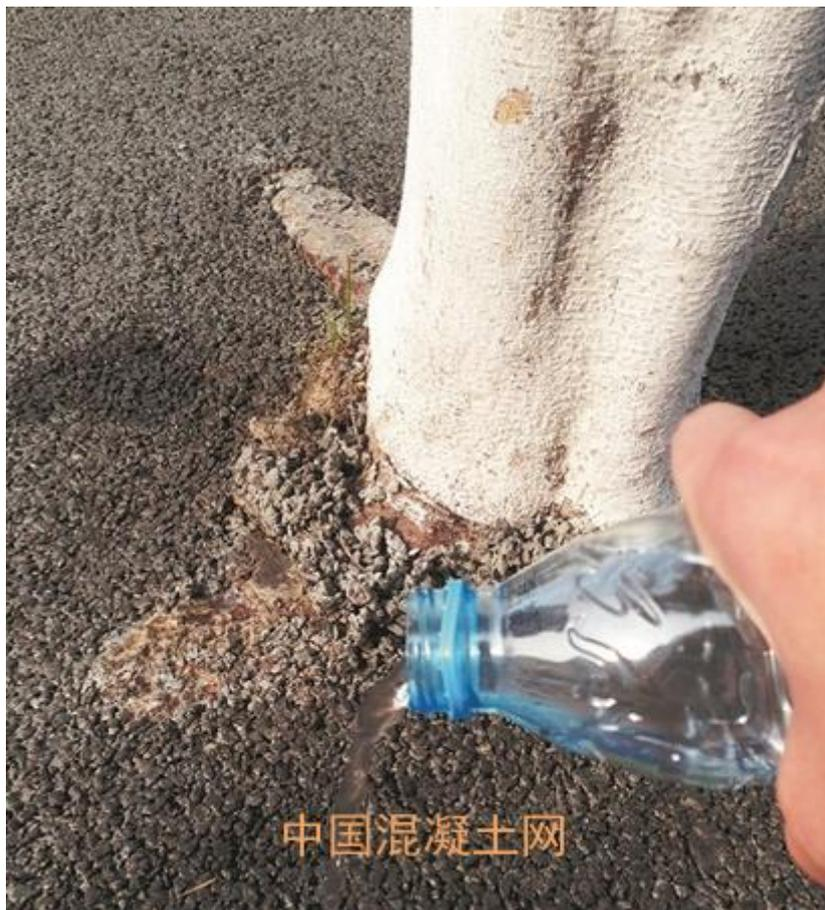
把一瓶水倒到透水混凝土上，瞬间被吸干
