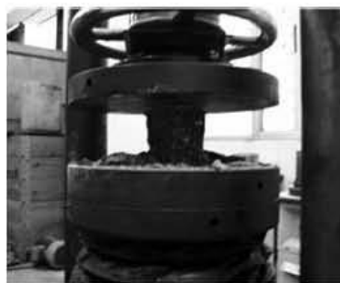
图 2 混凝土抗压试块制作
