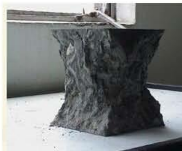
图 4 混凝土试块抗压
