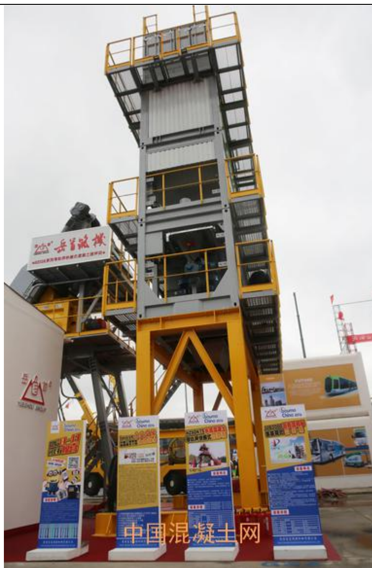
HZSKD75 型导轨秤快搬式水泥混凝土搅拌站
