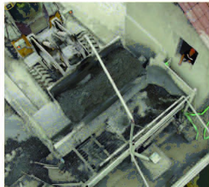
图 4 大批量未硬化混凝土的高效分离
